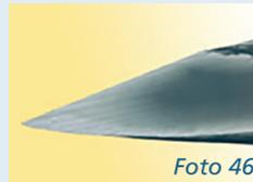
Mikroskopische Untersuchungen belegen, dass bereits nach einmaligem Gebrauch Schädigungen an der Pennadelspitze vorliegen, welche zu unnötigen Verletzungen der Haut und des Unterhautfettgewebes (Lipodystrophie) führen können.
